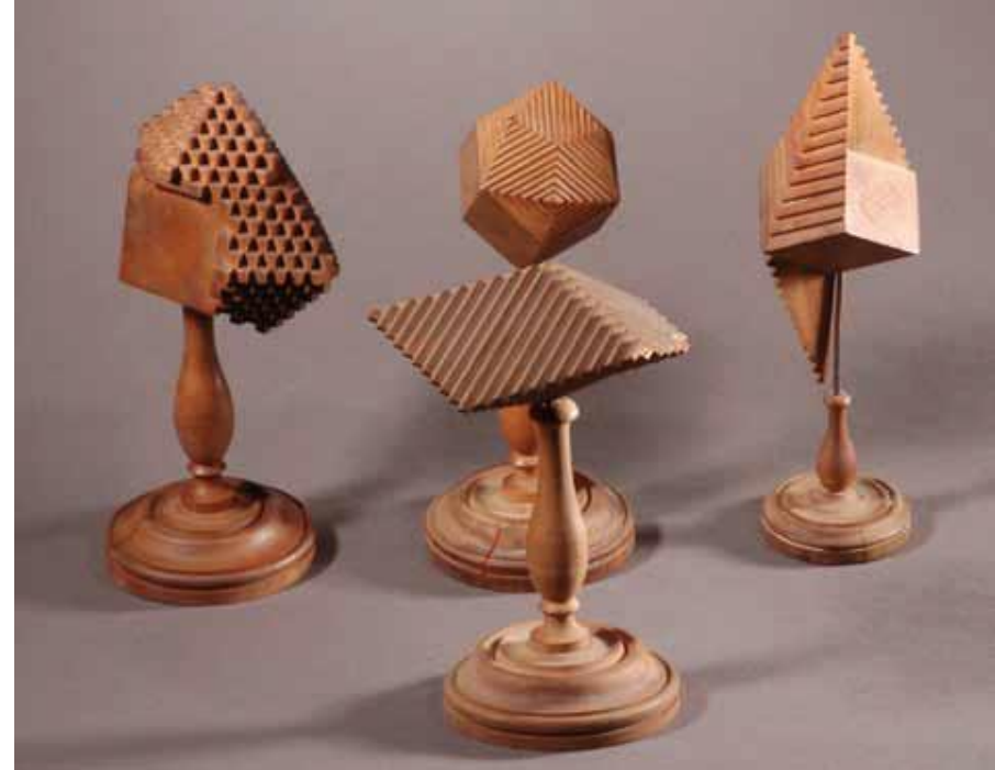
Modèle en bois faits par Haüy pour illustrer l'empilement de « briques » identiques expliquant les formes des cristaux.
